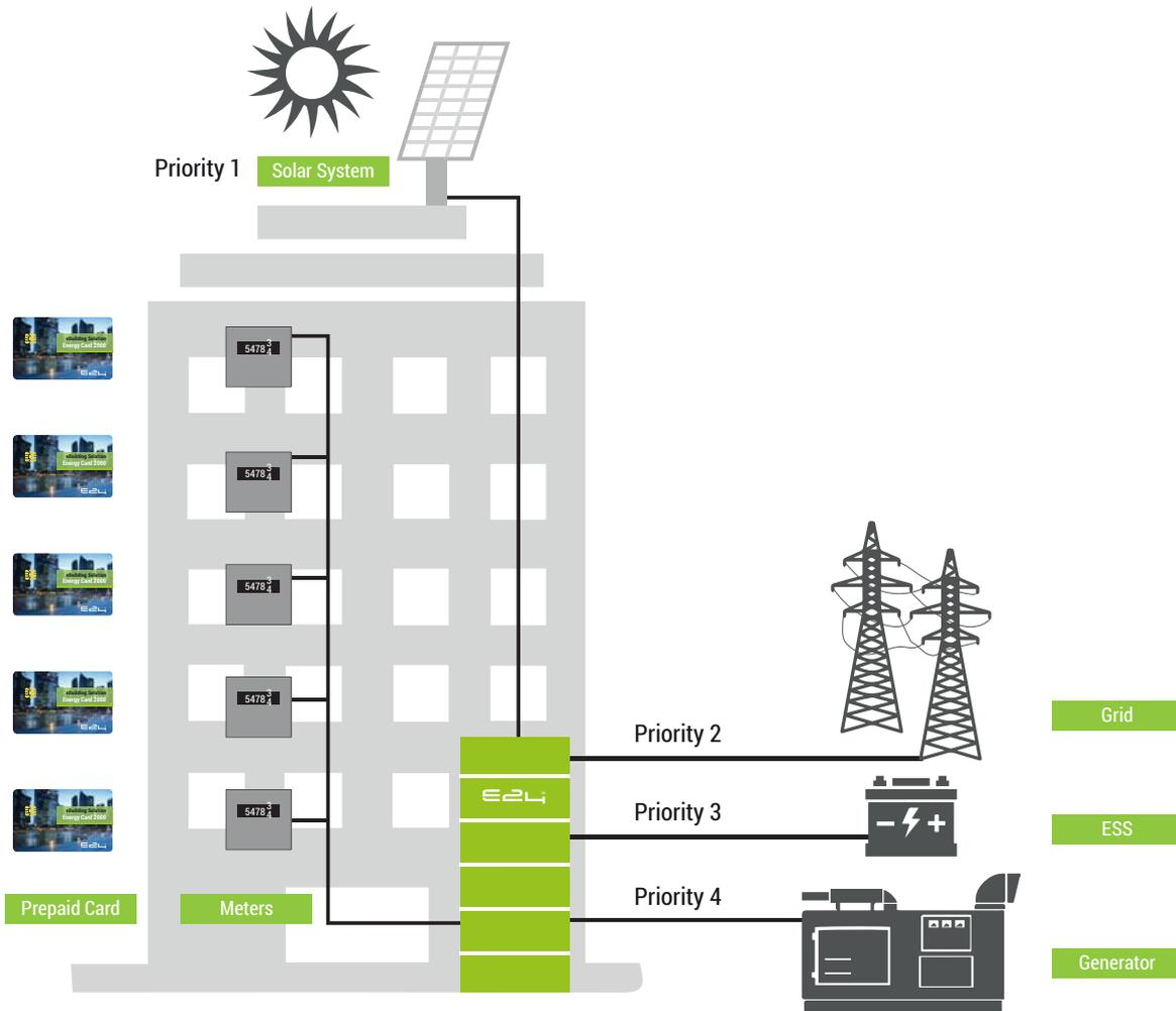
**eBuilding es una solución centralizada de almacenamiento de energía concebida para edificios en áreas donde la energía de los servicios públicos es intermitente. eBuilding comprende una solución centralizada de almacenamiento de energía y un sistema de gestión y facturación de energía. Sus principales funcionalidades incluyen:**
