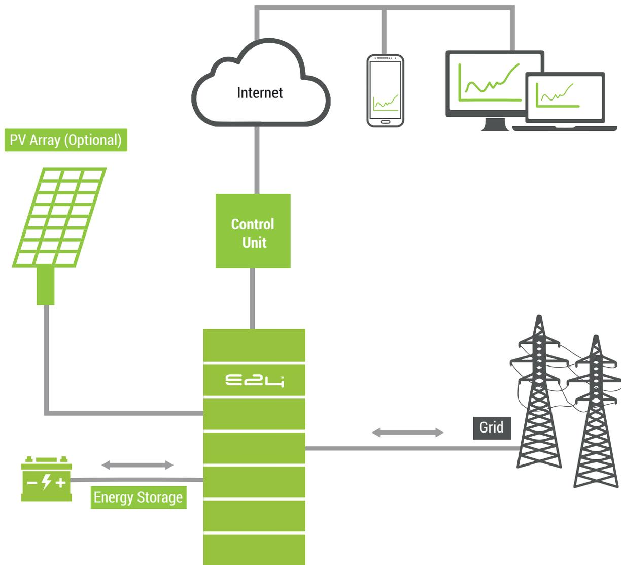
eGrid est une solution de stockage d'énergie qui se connecte au réseau en basse, moyenne ou haute tension pour se charger à partir du réseau ou pour alimenter le réseau en cas de besoin. eGrid peut éventuellement être associé à une installation photovoltaïque solaire pour alimenter le réseau en électricité à moindre coût.
