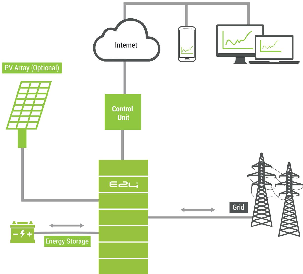
eGrid ist eine Energiespeicherlösung, die mit niedriger, mittlerer oder hoher Spannung an das Netz angeschlossen wird, um entweder eine Ladung aus dem Netz zu erhalten oder das Netz bei Bedarf mit Strom zu versorgen. eGrid kann optional mit einer Solaranlage gekoppelt werden, um das Stromnetz zu geringeren Kosten zu versorgen.
